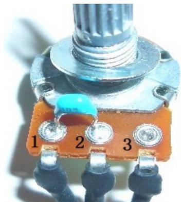
LCD コントラストボリュームには、0.1 $\mu$ F のコンデンサを、写真の位置に、取り付けます。
