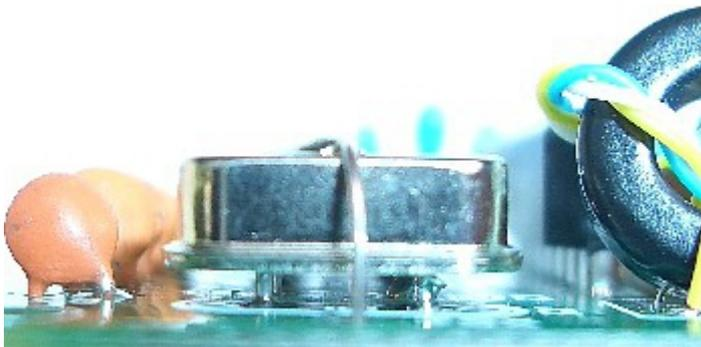
クリスタルは、左図のように基板から必ず、1mm~2mm浮かしてください。
