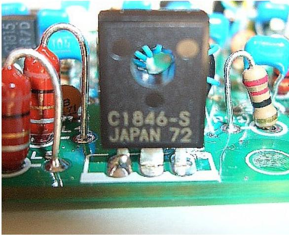
パワートランジスタ(Q6)は、写真のように刻印を基板の外側に向けて、取り付けます。
