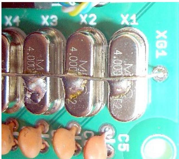
クリスタルのケースは、左図のようにGNDに接続します。XG1とXG2が、クリスタル用のGNDです。これも、必ず行ってください。
